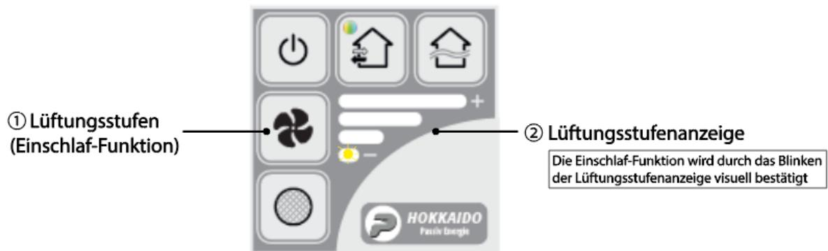
Wenn die Taste für die Einstellung der Lüftungsstufe ① länger als 2 Sekunden gedrückt wird, wird der Lüfter im Schlafzimmer (S-1) für 2 Stunden ausgeschaltet und nach 2 Stunden automatisch wieder gestartet. Die anderen Ventilatoren können wie gewohnt betrieben werden.
