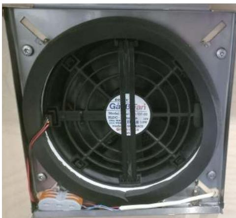
2. Lüfterkabel des Steckers mit der Klemme verbinden.
